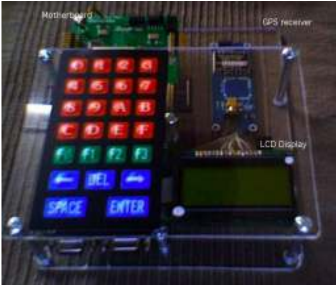
Figura 6.10: Prototipo del primer data logger que se ha desarrollado para la verificación de los taxímetros.
